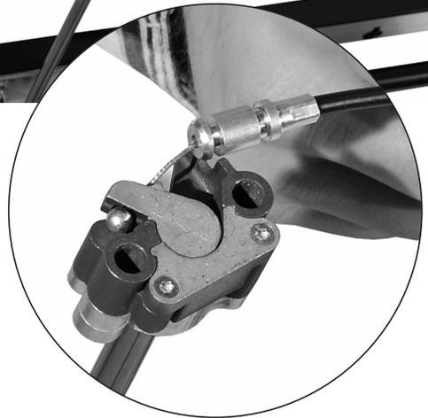
Führen Sie die Gasfeder ganz nach unten in den Säulenschacht ein. Die Nase des Gasfederkopfs zeigt dabei nach innen. Legen Sie den Bowdenzug in die Einsparung im Antriebskasten ein.
