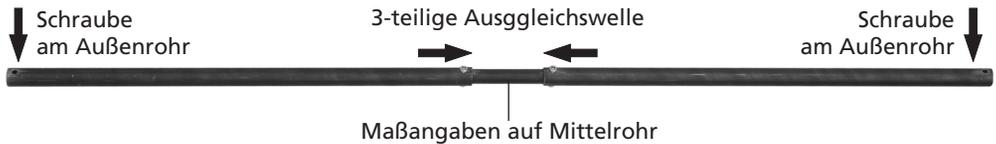
Verbinden Sie die 3 Röhren der Ausgleichswelle zu einer Stange. Die Schrauben an den beiden Außenrohren zeigen dabei nach außen.
