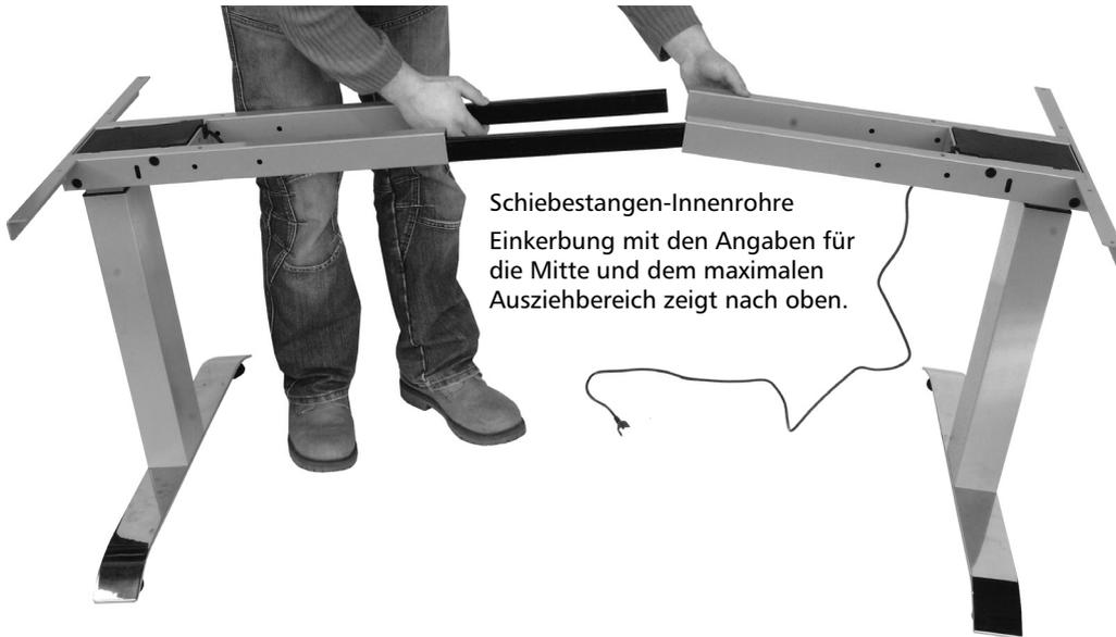
Heben Sie eines der Beine an und führen Sie die beiden langen Schiebbestangen in die Querstangen des Plattenträgers ein. Achten Sie darauf, dass die Einkerbung mit den Angaben für die Mitte und dem maximalen Ausziehbereich nach oben zeigt. Diese muss erkennbar sein, um die nachfolgende Breitenverstellung und Arretierung zu erleichtern.
