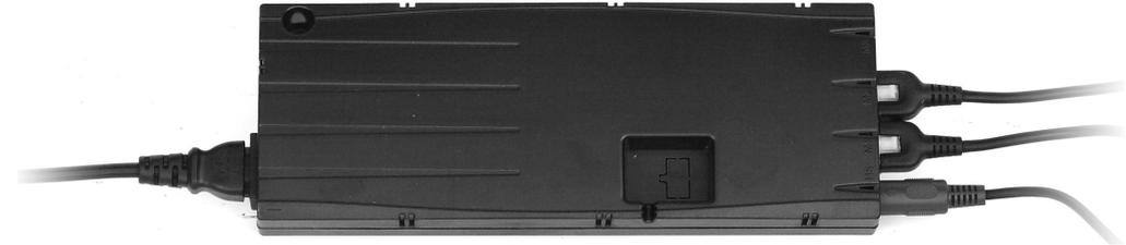
Verbinden Sie die beiden Kabel der Motoren mit der Steuerungsbox. Stecken Sie den Rundstecker des Up- and Down-Schalters bzw. des optionalen Memory-Schalters in die Steuerungsbox. Schließen Sie die Steuerungsbox mit dem Netzkabel an die Stromversorgung an. Testen Sie nun die elektrische Höhenverstellung.
