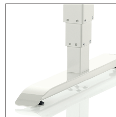
Motorische Höhenschnellverstellung (M4) Verstellbereich: 620-1270 mm Hub: 650 mm
