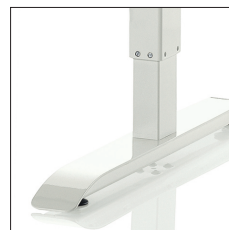
Motorische Höhenschnellverstellung (M2) Verstellbereich: 720-1220 mm Hub: 500 mm
