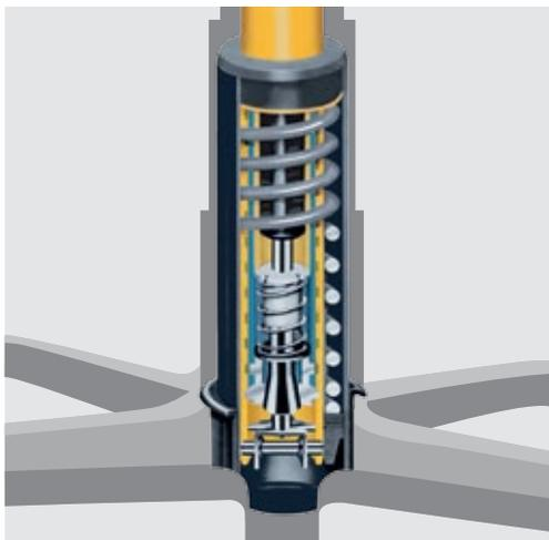
**Sedo-Lift-Mechanik.** Auch in der untersten Einstellung gewährleistet diese weltweit patentierte Sitzhöhenverstellung ein weiches, rückenschonendes Abfedern beim Hinsetzen. Im Führungrohr sind seitliche Nuten eingefräst, in denen die Mechanik einrastet. Die Gasfeder wird so entlastet und ist deshalb besonders langlebig. Gemäß den Sedus Garantiebedingungen für 30 Jahre.
